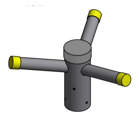
Aufsatzstück für 3 Leuchten Ausladung 0,25 m winklig Neigung 15 Grad (Ausleger durchgeh. zyl. 42,4 mm Durchmesser und um 120 Grad zueinander versetzt) mit Überwurf 240 mm lang mit 2 x 3 um 120 Grad versetzten Befestigungsschrauben, passend für Mastzopf = 76 mm, Ausleger und Überwurf mittels Kunststoffkappe geschlossen verzinkt
